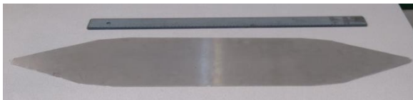
Fig. 5. Septum of the TEM cell.
