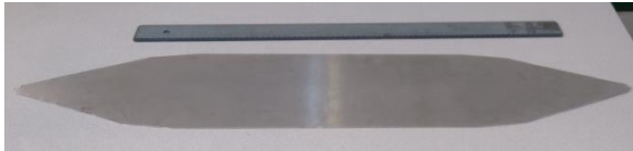
Fig. 5. Septum of the TEM cell.
